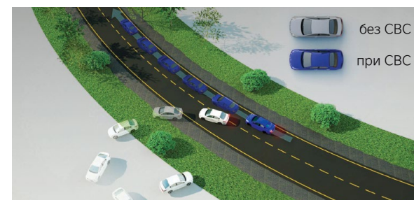
Система контроля торможения в поворотах (CBC) Благодаря перераспределению тормозных усилий система помогает пройти поворот по заданной траектории и предотвращает занос.
